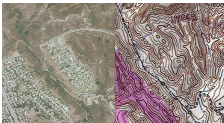
Рис.6. Обычная растровая графика, используемая в приложениях ГИС: аэрофотоснимок (слева) и ЦМР США (справа)
